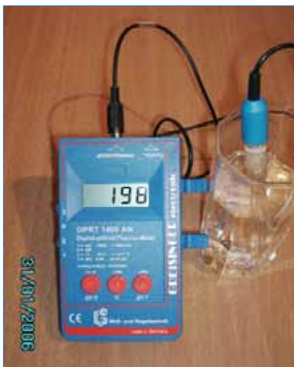
Abb. 1: Redoxpotenzialmessung von Leitungswasser (Ag/AgCl-Werte)
